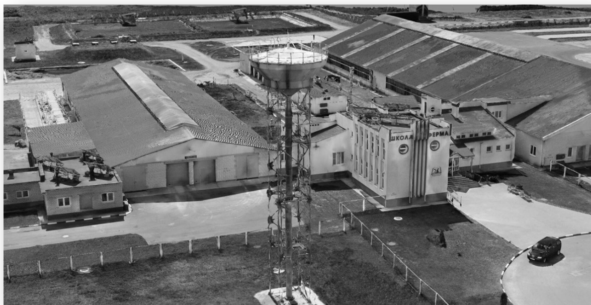
Рис. 2. Фрагмент 3D модели, созданной по результатам обработки материалов съемки в программном пакете Context Capture
