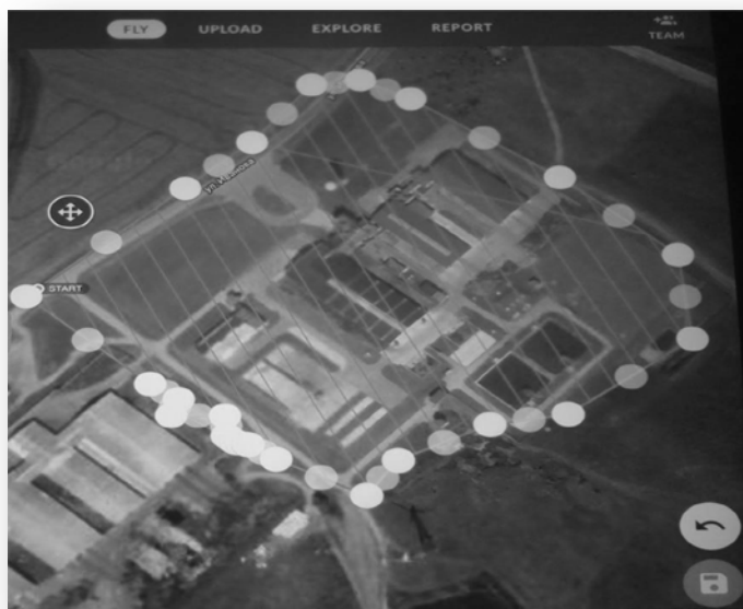
Рис. 1. Проект полета для БПЛА, созданный с использованием программного продукта DroneDeploy
